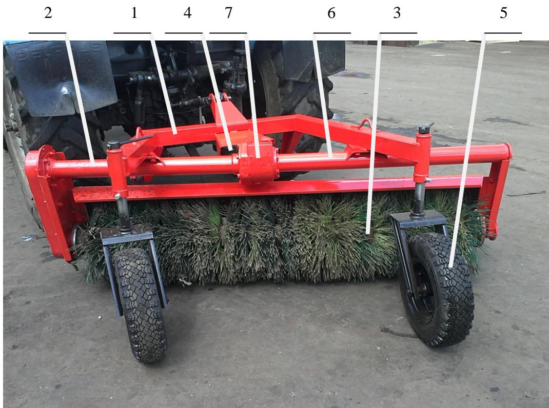
Рисунок 2. Устройство и основные узлы Щеточного оборудования.
