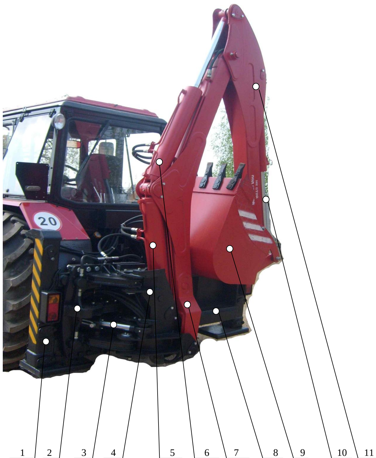
Рис.1 Общий вид и основные узлы экскаваторного оборудования 1 – аутригер, 2 – салазки, 3 – гидроцилиндр поворота поворотной опоры, 4 – поворотная опора, 5 – гидроцилиндр управления стрелой, 6 – гидроцилиндр управления рукоятью, 7 – стрела, 8 – направляющая салазок, 9 – ковш, 10 - гидроцилиндр управления ковшом, 11 - рукоять.
