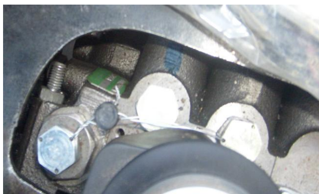
Рис.7 Пломбирование гидрораспределителя (в кабине, со стороны рабочего места оператора).
